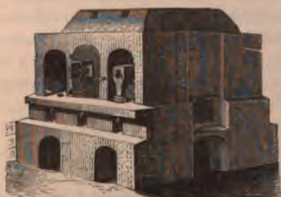
Fig. 222. — Four silésien pour l'extraction du zinc.
